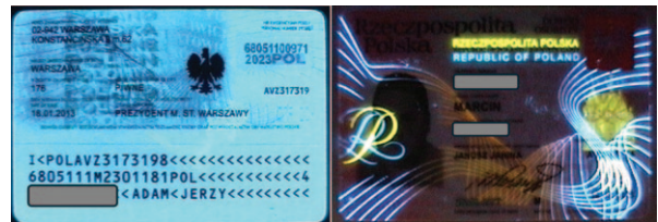
Fot. 2. Weryfikacja zabezpieczeń dowodu osobistego w świetle ultrafioletowym (fotografia 1 – egzemplarz sfalszowany, fotografia 2 – egzemplarz autentyczny)
